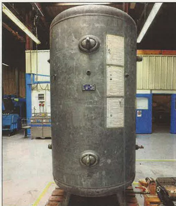
Dieser Tank wurde zuvor vom Kompressor mit Druckluft befüllt – das ständige Hochfahren des Systems benötigte sehr viel Energie.
